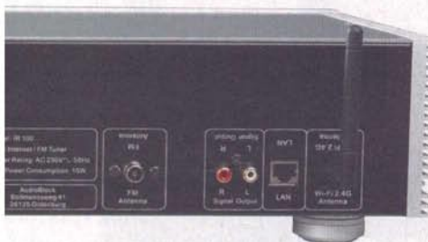
Fenster zur Welt: Musikdaten erreichen den IR100 über FM, Ethernet oder WLAN-Antenne
